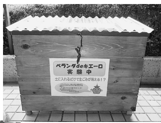
▲「ベランダdeキエーロ」は、神奈川県葉山町で考案された土の力で生ごみを分解する生ごみ処理容器です。
